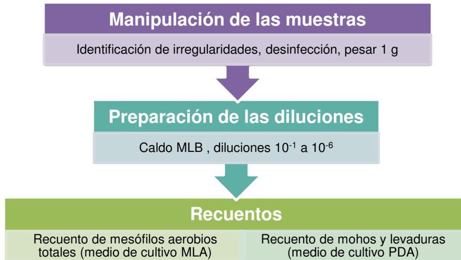
**Figura 6. Esquema de la preparación preliminar de las muestras y los recuentos**
