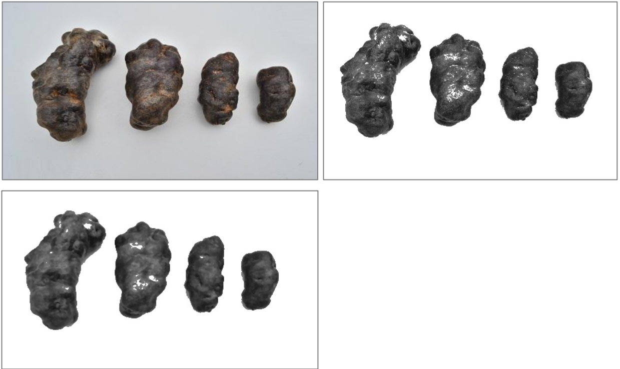
Figura 4-6 Proceso donde se muestra la aplicación del filtro de la mediana para la reducción del ruido sobre las imágenes en escala de grises de la muestra 2.
