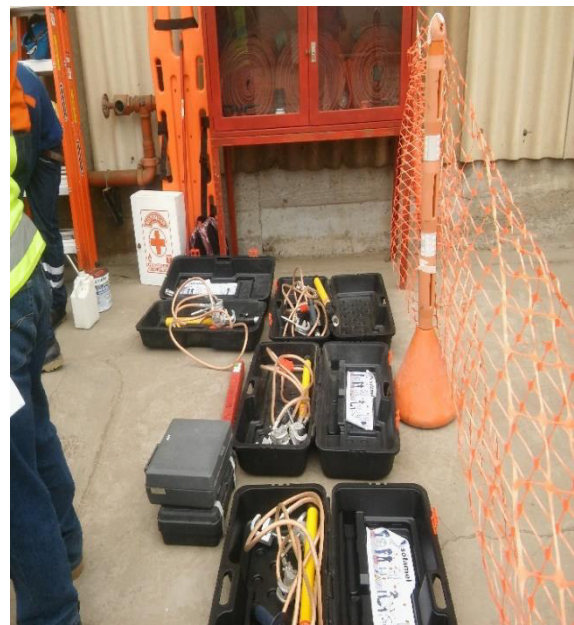
Inspección de kit de puesta a tierra
