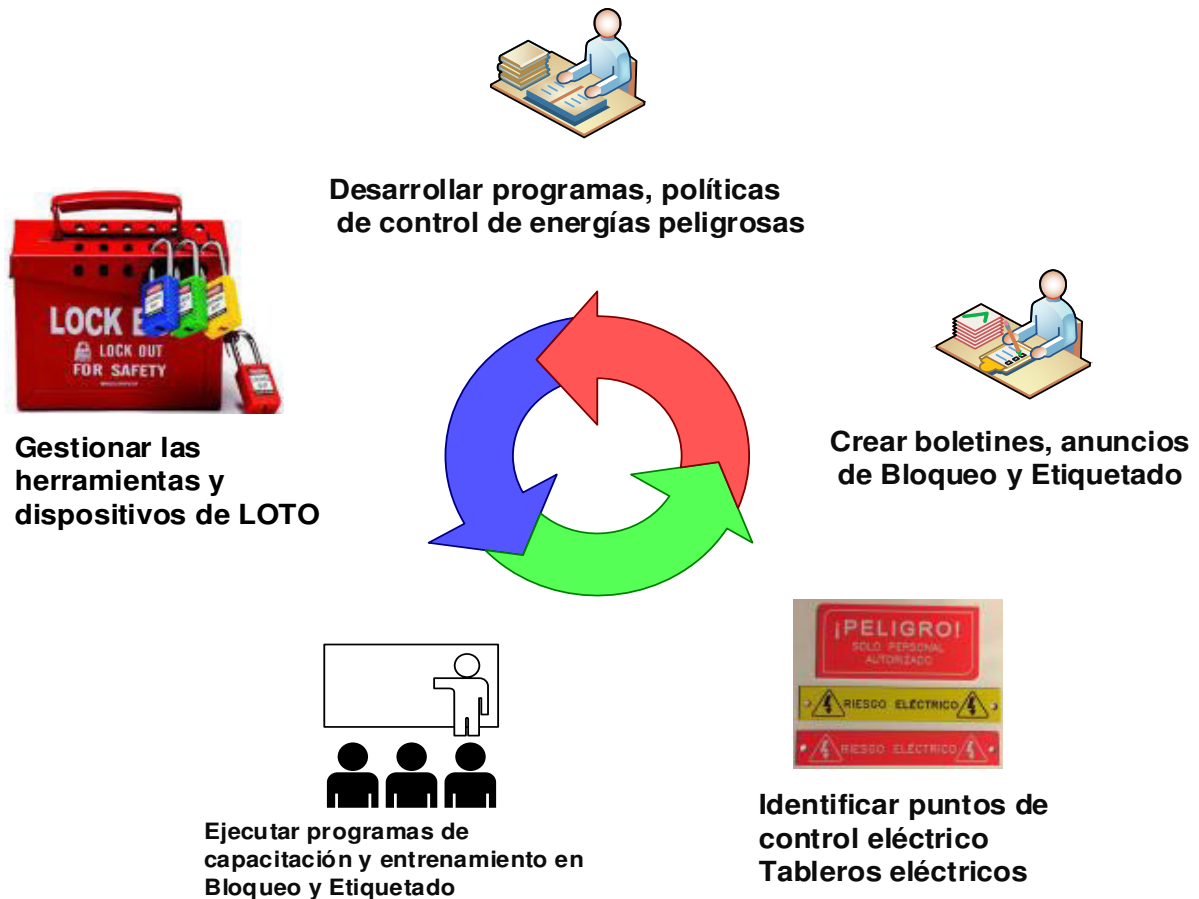
Figura N° 10: Sistema de control de energías peligrosas
