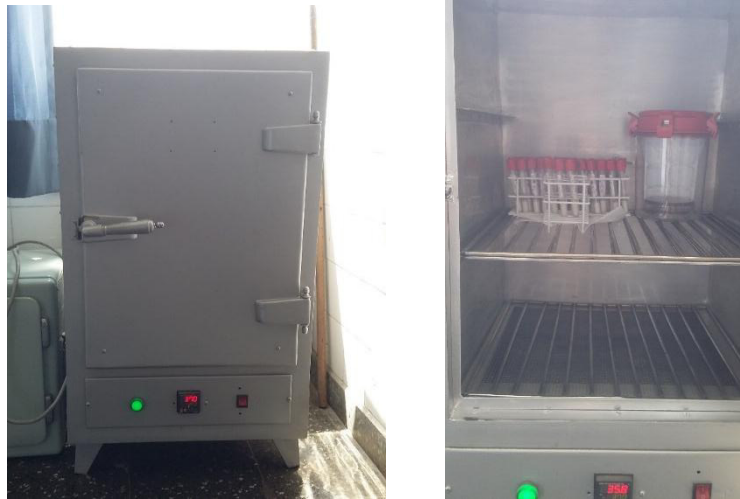
Figura 5. Incubación de piezas a 37°C durante 5 días
