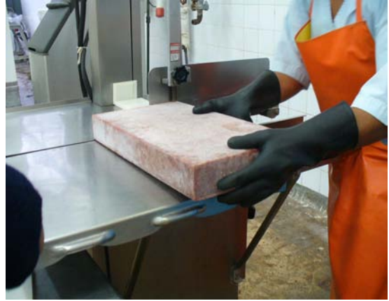
Figura 7. Trozado de la pulpa de anchoveta
