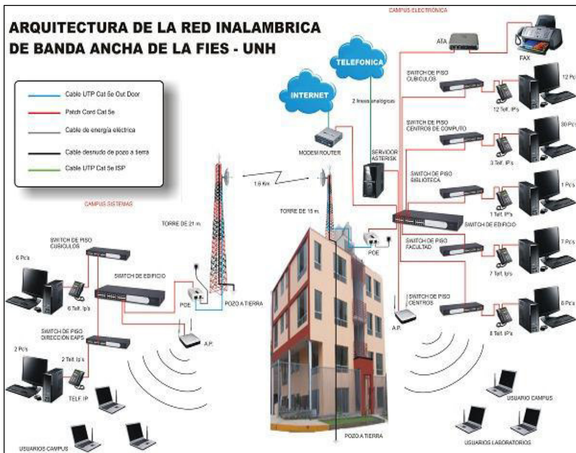
Figura 2.8 – Arquitectura de la Red Inalámbrica de telefonía IP FIES-UNH.
