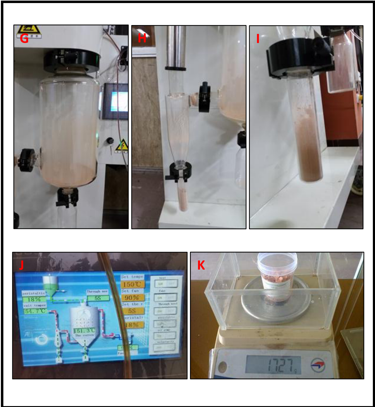
Figura 43. Obtención del extracto de semilla de unguahui microencapsulado (EUM) A, B, C, D y E. Preparación de la solución de alimentación, F. Equipo mini-Spray Dryer, G. Cámara de secado, H. Ciclón separador, I. Botella colectora, J. Condiciones de secado, K. Pesado del EUM
