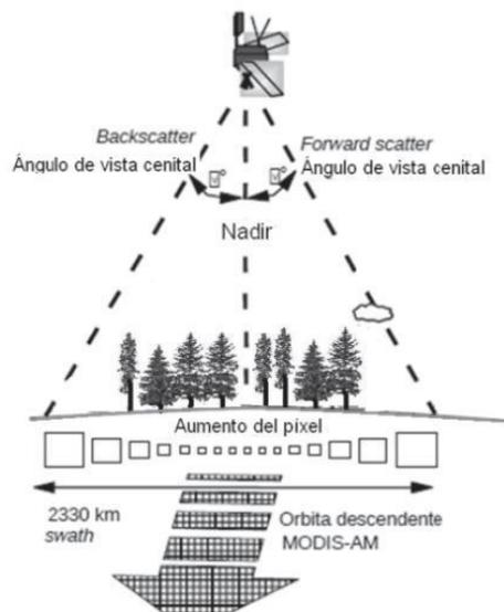
Figura 2-21. Deformaciones relacionadas con el ángulo de barrido (Mora, 2010).
