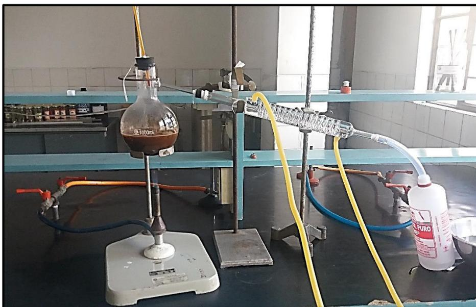
**Figura N° 8:** Equipo de destilación simple
