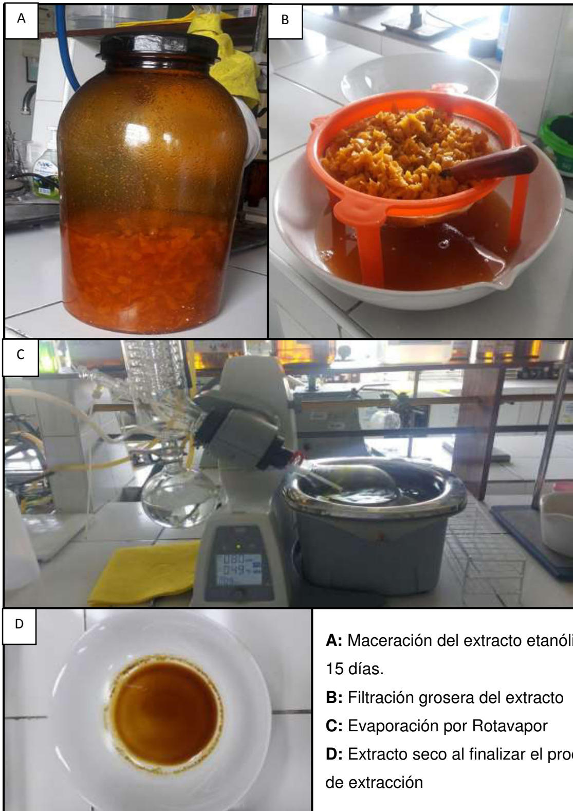
Figura 20. Elaboración del extracto etanólico de Vasconcellea weberbaueri (Harms)
