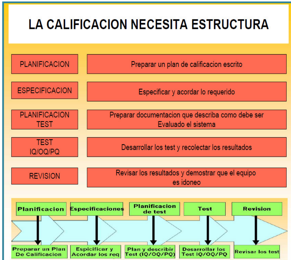
Figura 2. Estructura de la Calificación de una Máquina Fuente: Calificación de máquinas y equipos utilizados en la producción y acondicionamiento farmacéutico-Quality Assurance
