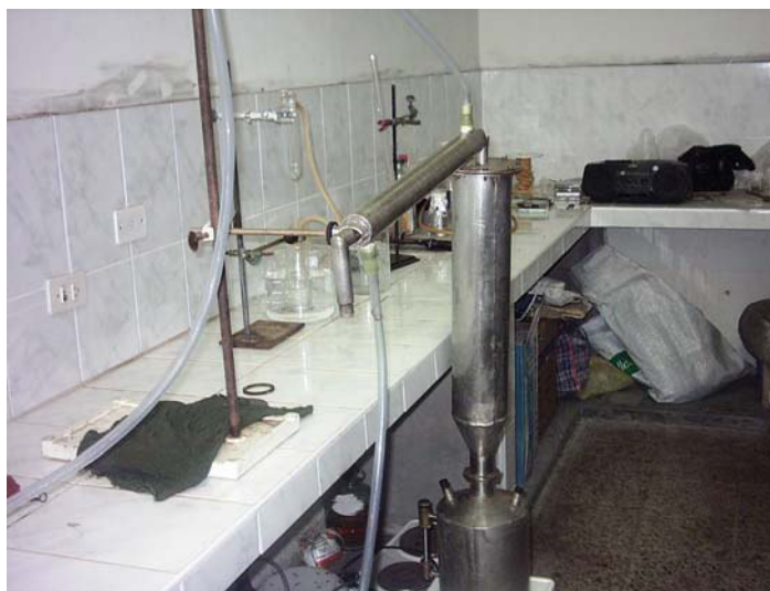
Fig. 2.7: Equipo de hidroextracción ensamblado
