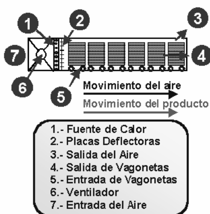
Fig 1.11: (a) Secador de dos plantas,. (b) Secador de Bandeja,. (c) Secador de túnel con flujo concurrente, (d) Secador de túnel con flujo contracorriente
