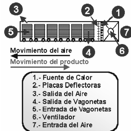
Fig 1.11: (a) Secador de dos plantas,. (b) Secador de Bandeja,. (c) Secador de túnel con flujo concurrente, (d) Secador de túnel con flujo contracorriente
