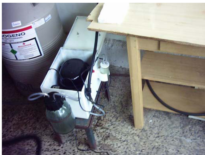
Fig 2.9: Equipo de fraccionamiento : Generador de vacío.
