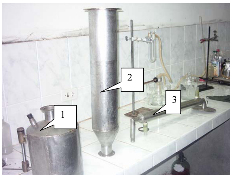
Fig. 2.5 : Partes del equipo extractor de aceites esenciales; 1. boiler, 2.columna, 3 condensador.
