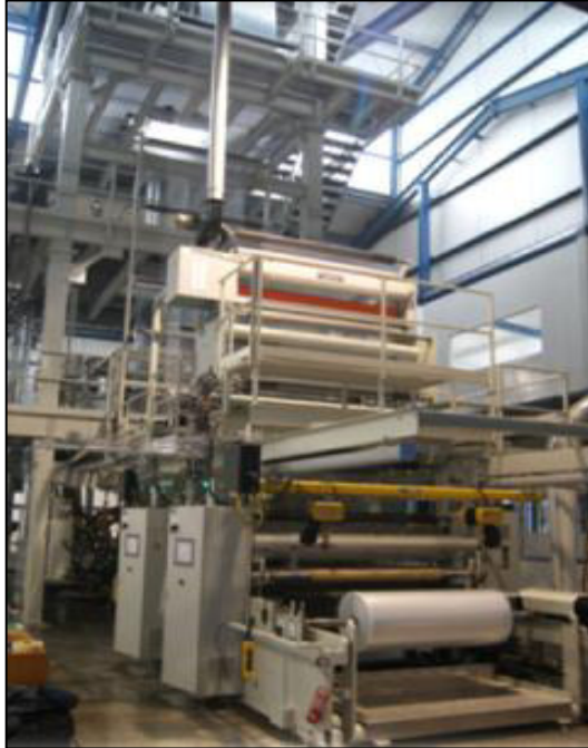
Figura 7. Máquina extrusora de 7 capas. Fuente. Área de Comunicación Interna – TRUPAL S.A
