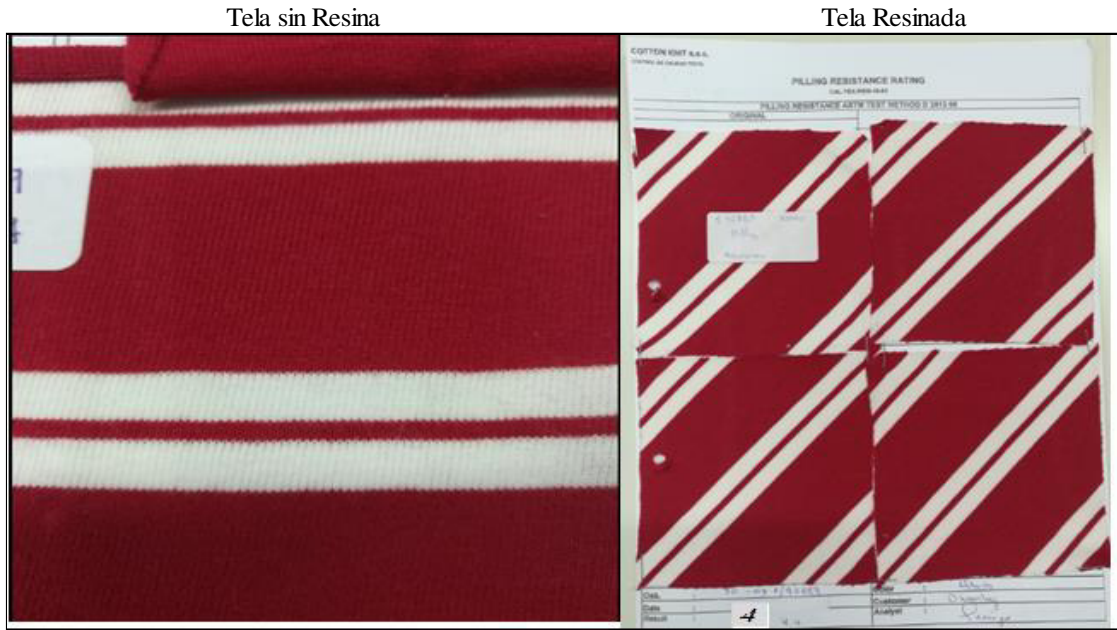
Figura 25 Tela Resinada para mejorar la apariencia, hasta pilling grado 4 (Método Rating D3512-96). Fuente: datos CK. (Elaboración propia)
