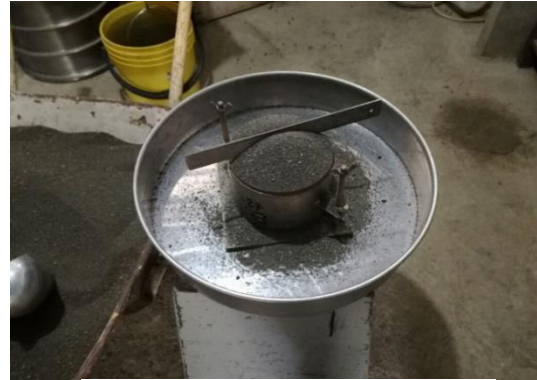
Ensayo de masa unitaria compactada
