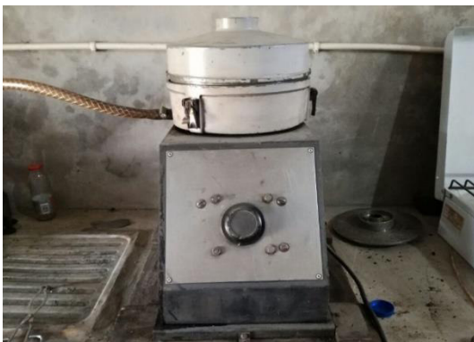
Extracción de asfalto
