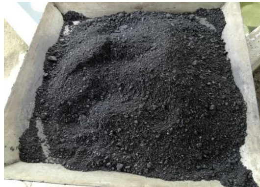
Material reciclado calentado para molde de briqueta
