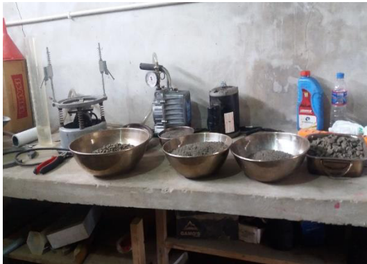
Materiales para mezcla 1/2, 3/8, cisco y arena
