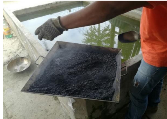
Adición de polvo neumático en reciclado
