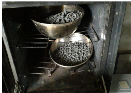
Secado con horno 110° C
