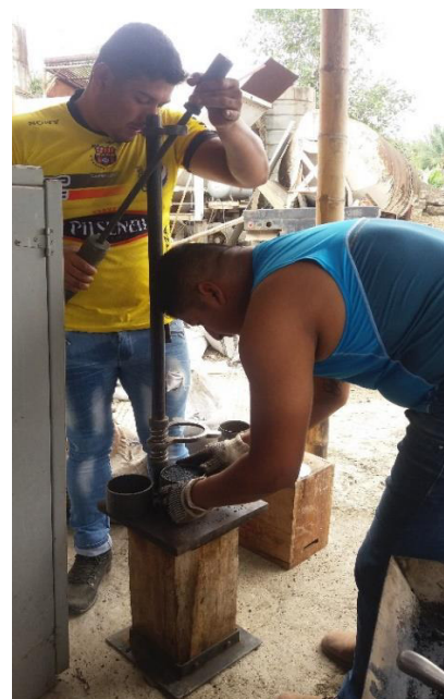
Colocación de materiales en briquetas
