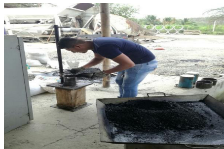
Moldeo de briquetas
