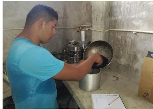
Adición de asfalto en molde
