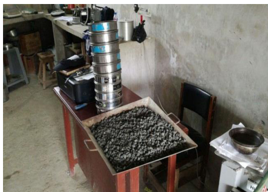
Ensayo granulométrico, preparación muestras
