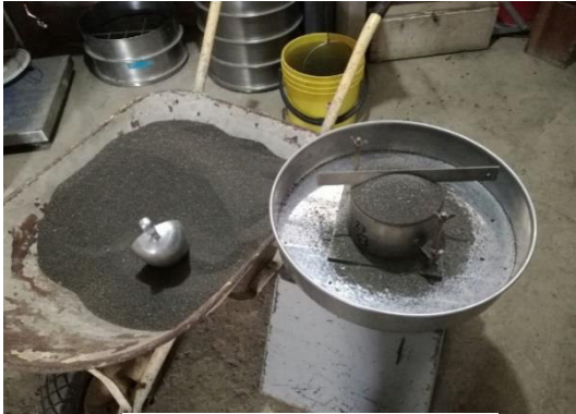
Ensayo de masa unitaria suelta
