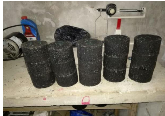
Briquetas para ensayo Marshall
