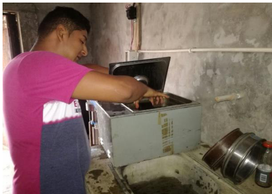
Colocación de briquetas a baño maría
