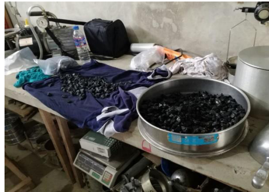
Peso superficie saturada seca luego de 24 horas
