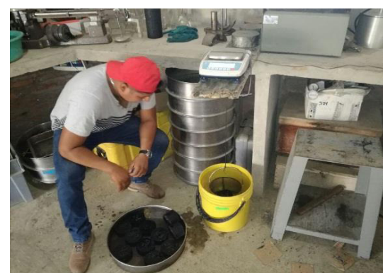
Rotura de briquetas, estabilidad, flujo
