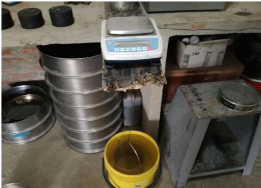
Gravedad específica de gruesos, peso sumergido
