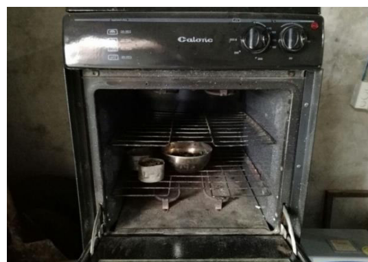
Secado en horno 24° hasta 110°
