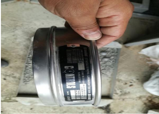
Tamiz # 12, luego del procedimiento en la máquina de los ángeles
