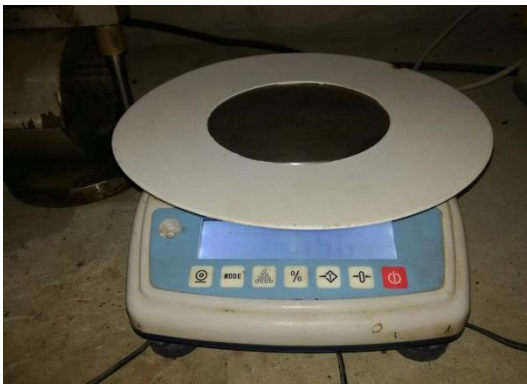
Pesado de filtros
