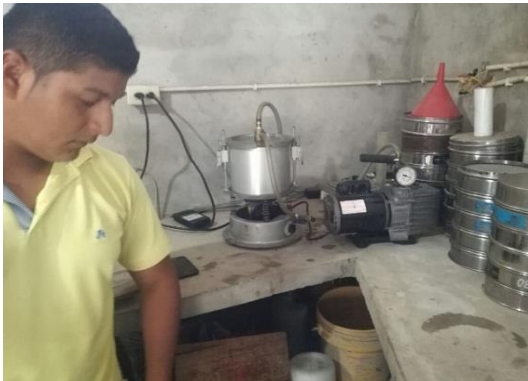
Extracción en bomba de vacío
