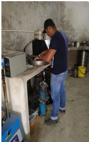
Colocación de briquetas en agua por 30 min.
