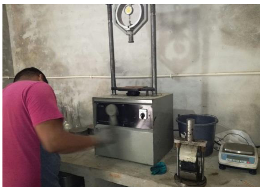
Preparación para ensayo Marshall
