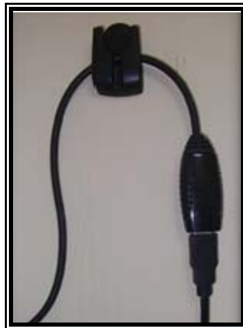
Foto 8. Conexión del sensor al programa digital X- ray system sopix.
