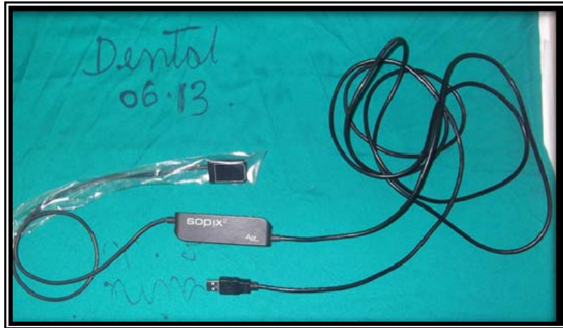
Foto 9. Sensor y conexión “digital X- ray system sopix “.
