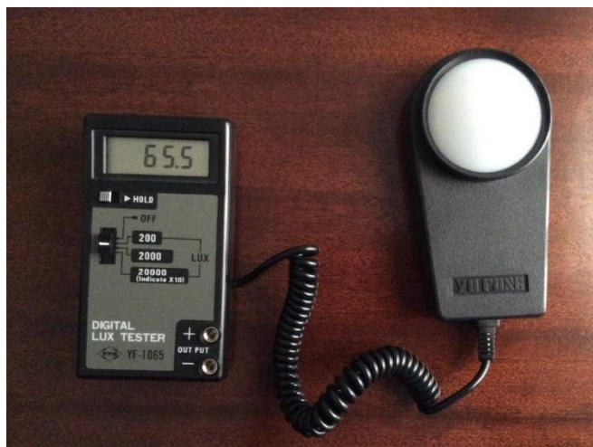
Figura 5.14 – Luxímetro usado no teste de distância e luminância
