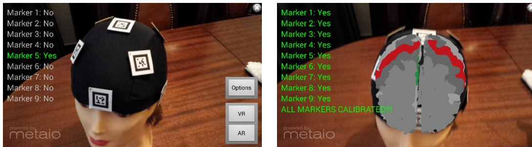
Figura A.3 – Ecrã do modo de RA durante (esquerda) e no final (direita) do processo de calibração das marcas
