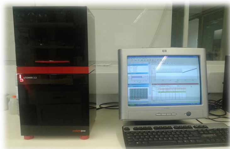
Figura 3.5 - Equipamento qTower 2.2 e o software qPCR Soft 1.1, utilizados no PCR quantitativo em tempo real.
