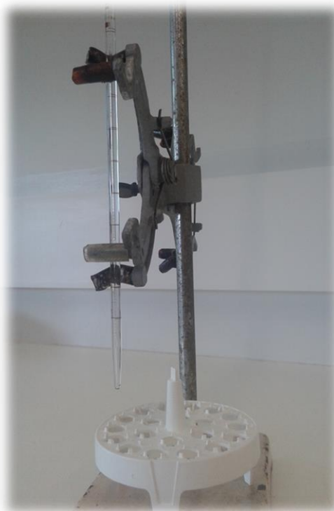
Figura 3.4 – Aparatus usado: Pipeta de vidro de 0,1 ml utilizada na medição da viscosidade das amostras.
