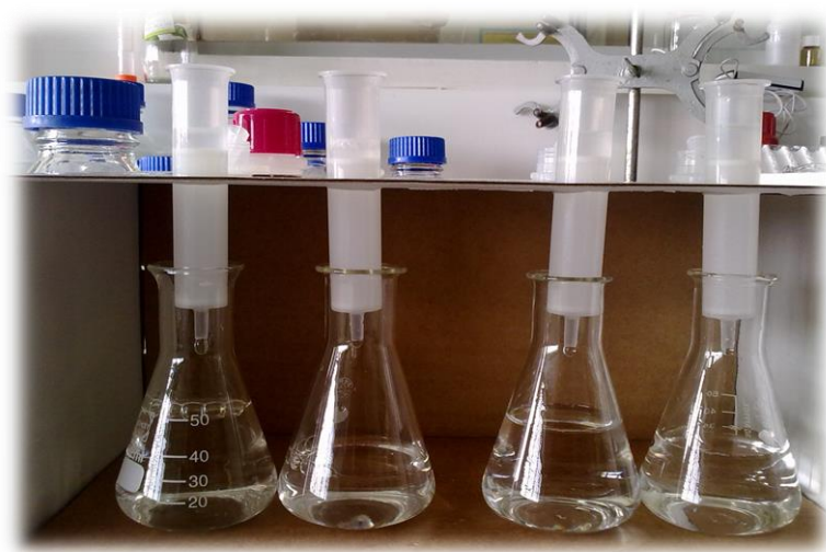
Figura 3.3 – Aspecto do apparatus montado para a troca do tampão das amostras com colunas PD10.
