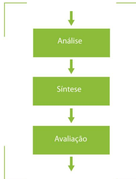
Figura 9. Representação do modelo de Chris Jones. (Fonte: adaptado de JONES , 1963, por Susana Rodrigues, 2013)
