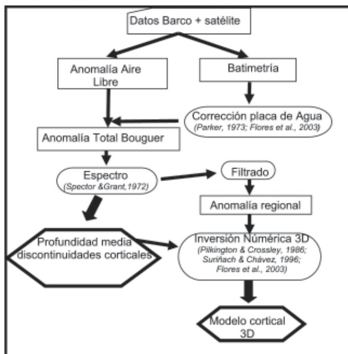
Fig. 3.- Esquema del proceso seguido para la obtención de los modelos corticales.
