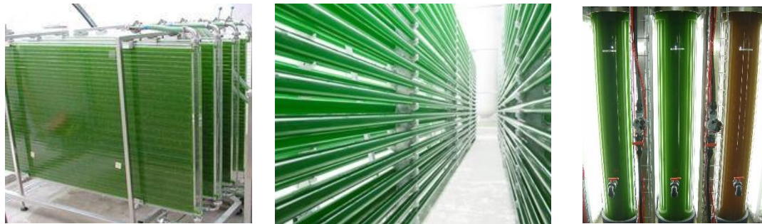
Fig. 3 – Exemplo de fotobioreatores fechados. Da esquerda para a direita: FBR's planares, tubulares e de colunas.
