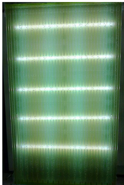
Fig. 8 – Fotobioreator planar alveolar com cultura de N. oleoabundans e a disposição das lâmpadas fluorescentes.
