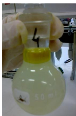
Fig. 15 – Separação de fases no final do tratamento da amostra pelo método do trifluoreto de boro.
