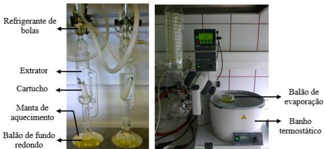
Fig. 14 – Extração da fração lipídica presente na biomassa microalgal em Soxhlet (figura da esquerda) e evaporação do hexano no rotavapor (figura da direita).
