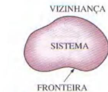
Figura 3.1. Representação de um sistema termodinâmico, sua fronteira e vizinhança (Retirado de http://profrobsonmarinho.blogspot.pt/2013/03/sistema-e-volume-de-controle.html a 20 de Agosto de 2014).
