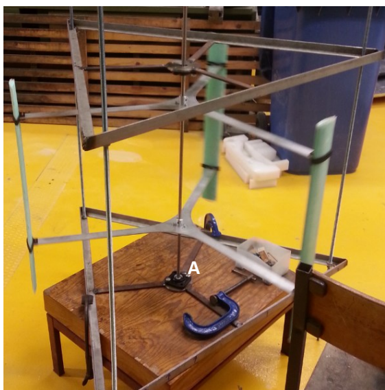
Figura 40 - Montagem do rotor
