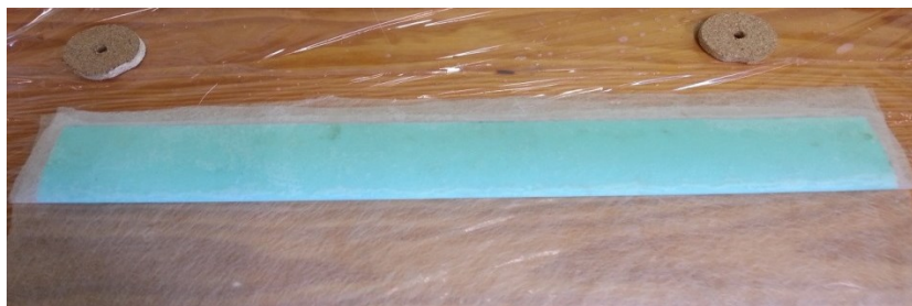
Aplicação do revestimento em fibra de vidro
