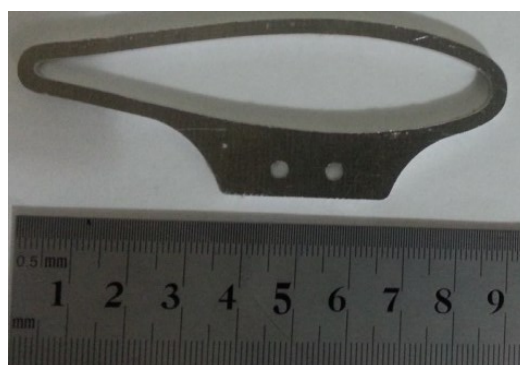
Figura 44 - Perfil em alumínio para as pás de 8cm de corda
