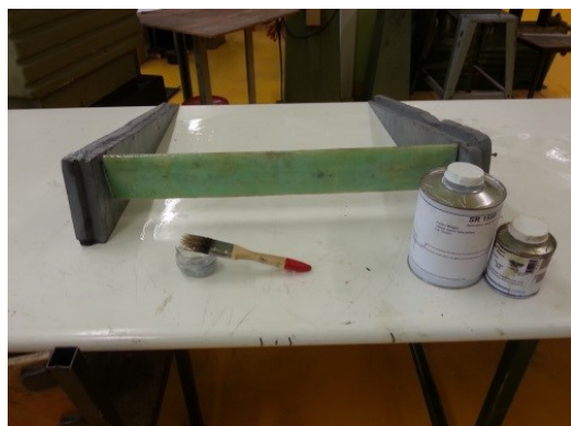
Figura 47 - Acabamento com resina epóxi
