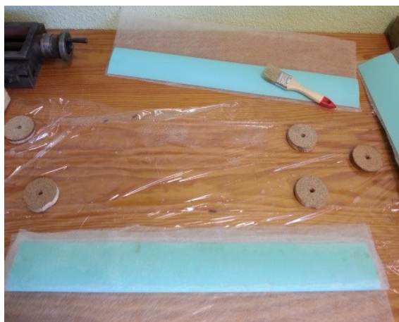
Figura 45 - Revestimento Fibra de vidro
