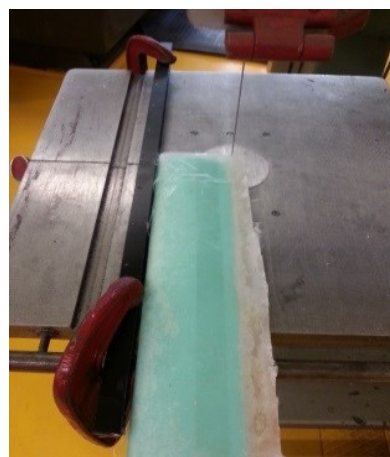
Figura 46 - Corte do excesso de fibra de vidro
