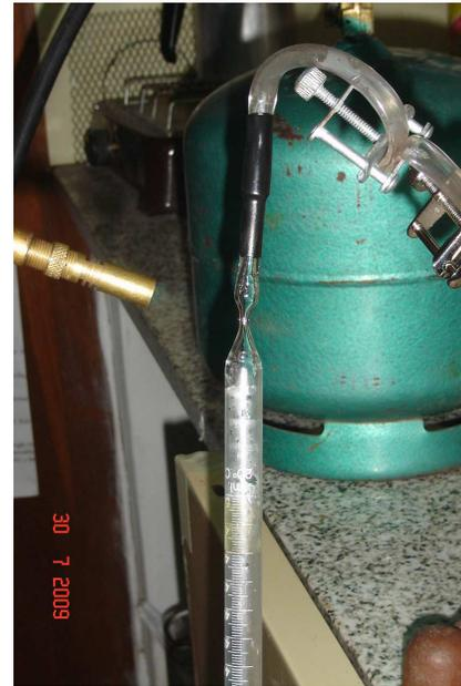
Figura 1. Bureta empleada como tubo de calor.
