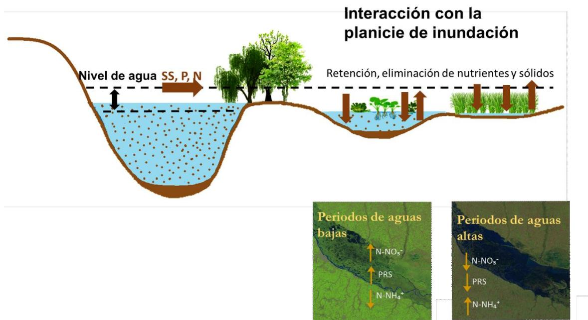
**Figura 6.8.** Esquema conceptual de la interacción de nutrientes y sólidos con la planicie y los pulsos de inundación.
