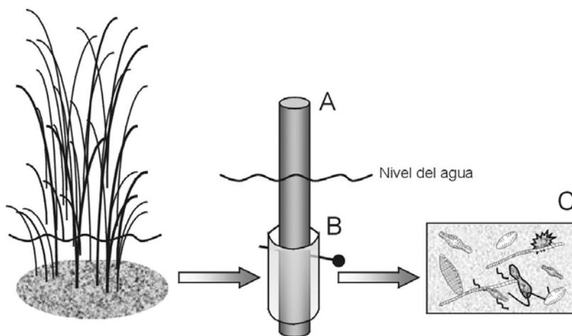
**Fig. 4.** Empleo de sustratos artificiales en el Río de la Plata. A: detalle de la porción basal del junco empleado como soporte, B: acetato sujeto al tallo por medio de una grampa, C: sustrato artificial colonizado para su análisis.
