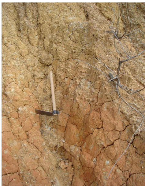
Figura 118 - Material relativamente argiloso alaranjado a avermelhado (formação 4), tal como ocorre na forma F29. Notar a ocorrência generalizada de fracturas de dessecação.
