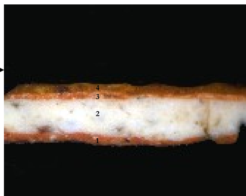
Figura 7. Corte transversal: visualizam-se duas finas camadas cromáticas, cor-de-laranja (4) e cor-de-rosa (3), sobre um estrato espesso branco (2) e uma camada subjacente cor-de-laranja (1).
