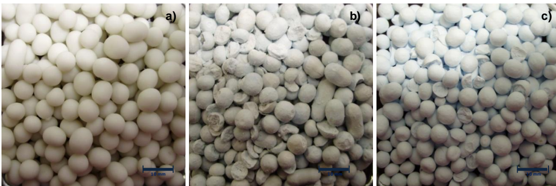
Figura 9.5.3. Imagem dos pellets da formulação F6_S15_A, antes da sinterização (a), após sinterização a 1000°C (b) e após sinterização a 1200°C (c).
