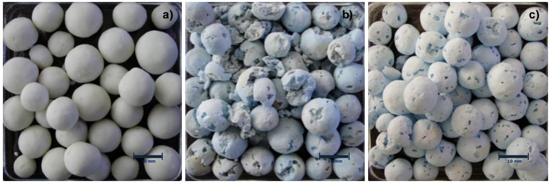
Figura 9.5.16. Imagem dos pellets da formulação F9_S40_C, antes da sinterização (a), após sinterização a 1000°C (b) e após sinterização a 1200°C (c).
