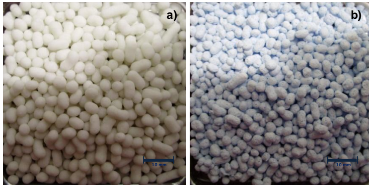
Figura 9.5.13. Imagem dos pellets da formulação F3_S40_B, antes da sinterização (a) e após sinterização a 1000°C (b).
