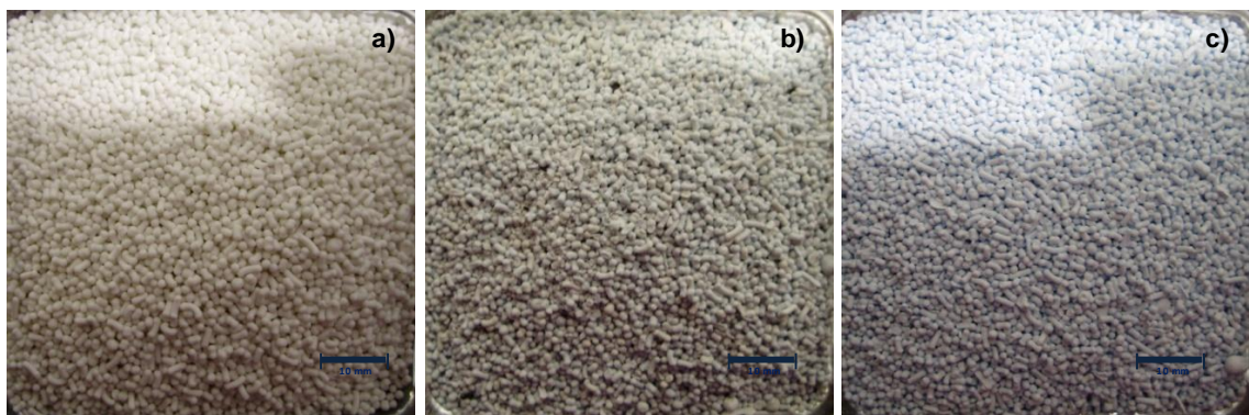
Figura 9.5.5. Imagem dos pellets da formulação F1_S15_B, antes da sinterização (a), após sinterização a 1000°C (b) e após sinterização a 1200°C (c).
