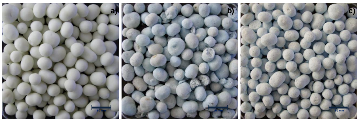
Figura 9.5.11. Imagem dos pellets da formulação F6_S40_A, antes da sinterização (a), após sinterização a 1000°C (b) e após sinterização a 1200°C (c).
