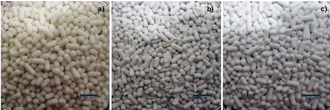
Figura 9.5.2. Imagem dos pellets da formulação F3_S15_A, antes da sinterização (a), após sinterização a 1000°C (b) e após sinterização a 1200°C (c).
