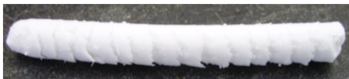
Figura 4.1. Superfície do extrudido (feira de diâmetro 6 mm, velocidade de 400 mm/min, menor proporção de água – A50_C50_V4_L/D4).
