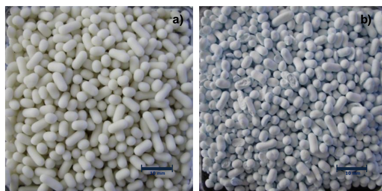
Figura 9.5.6. Imagem dos pellets da formulação F3_S15_B, antes da sinterização (a) e após sinterização a 1000°C (b).
