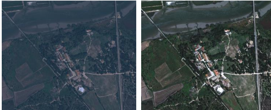
Figura 31 – Recorte da Área de Estudo de Palmela, (à esq.) a fusão das 4 bandas na composição colorida RGB (321) e (à dir.) a mesma fusão das 4 bandas mas com otimização linear
