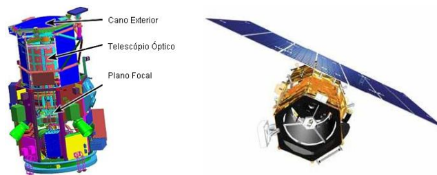
Figura 1 – (à esq.) Estrutura Interna do Satélite GeoEye-1; (à dir.) Satélite GeoEye-1 Fonte: [Adaptado de EoPortalDirectory, 2014]
