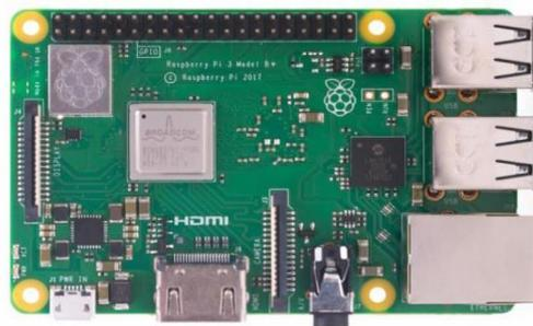
Figura 2.14 - RaspberryPi 3b+ [28]
