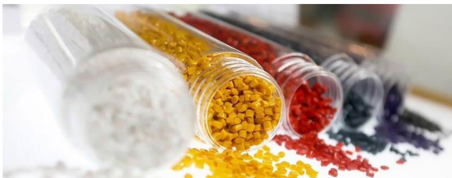
Figura 32. Grânulos de plástico que serão fundidos no processo de moldagem por injeção. Fonte: https://ferplastic.wordpress.com/2016/10/13/como-funciona-a-injecao-plastica/
