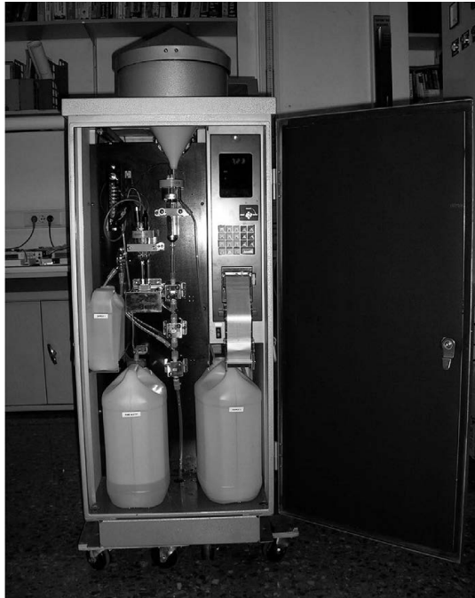
Figura 9. Analizador de lluvia ácida instalado en Torre Miró (1.223 m), marca Kimoto, modelo AR-106.
