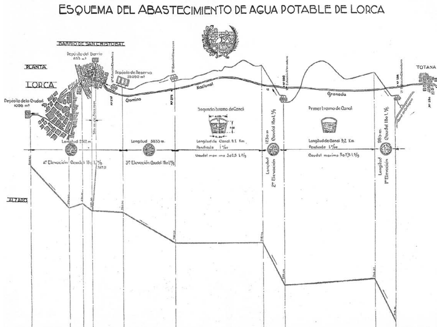
Figura 6. Esquema del trazado del “Proyecto de abastecimiento de agua potable de Lorca” del año 1946 (Fuente: MCT).
