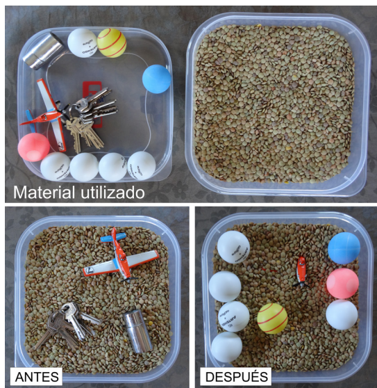
Fig. 8. Experimento sencillo para reconocer cómo durante la agitación del sedimento, si existe un gradiente de densidad invertido, se produce la migración vertical del material. Se han utilizado tres materiales: (1) objetos metálicos de densidad mayor, (2) lentejas de densidad intermedia y (3) pelotas de ping-pong de densidad más baja. Antes de agitar, los objetos metálicos se han situado en la superficie de las lentejas y las pelotas de ping-pong se han enterrado en ellas. En la fotografía inferior derecha (DESPUÉS) se observa la situación después de agitar (terremoto).
