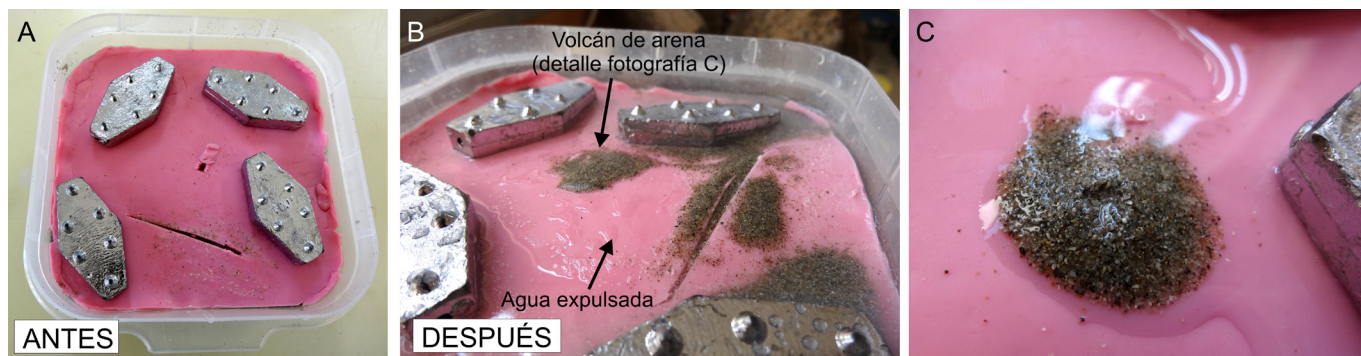
Fig. 14. Experimento para reproducir volcanes de arena. En una fiambarrera (tupper ware) se ha vertido arena muy fina completamente saturada en agua. Sobre ella se ha colocado una capa de plastilina de aproximadamente medio centímetro de espesor. Antes de agitar, se ha roto la capa de plastilina en dos lugares, en uno de forma puntual y en otro lineal (simulando una fractura). Estas roturas facilitan la expulsión de agua y arena. Los plomos de pescar que aparecen en la fotografía son para evitar que el agua “levante” la plastilina separándola de la arena. De esta manera, el agua termina por llegar a la superficie arrastrando arena y formando pequeños volcanes, similares a los que ocurren durante terremotos reales.
