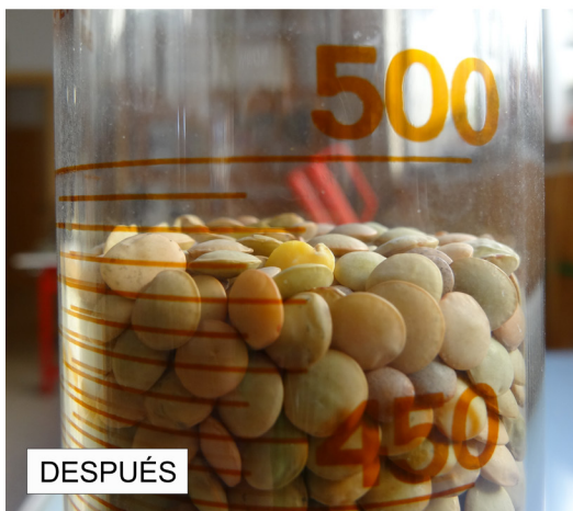
Fig. 11. Una experiencia muy sencilla se puede realizar rellenando una probeta graduada con arena o con cualquier “elemento detrítico” (en el ejemplo se han utilizado lentejas). Se puede comprobar cómo después de agitar se produce una reorganización y una compactación (ver Figs. 5 y 9).
