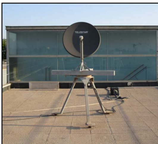
Figura 5. Antena receptora de imágenes Meteosat Segunda Generación (imagen izquierda) y PC donde se tratan las imágenes de satélite (imagen derecha). Fotos del autor.
