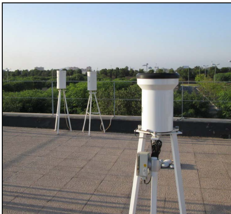
Figura 4. Pluviómetro de última generación (Delta OHM) y Pluviómetros (al fondo de la imagen). Foto del autor.
