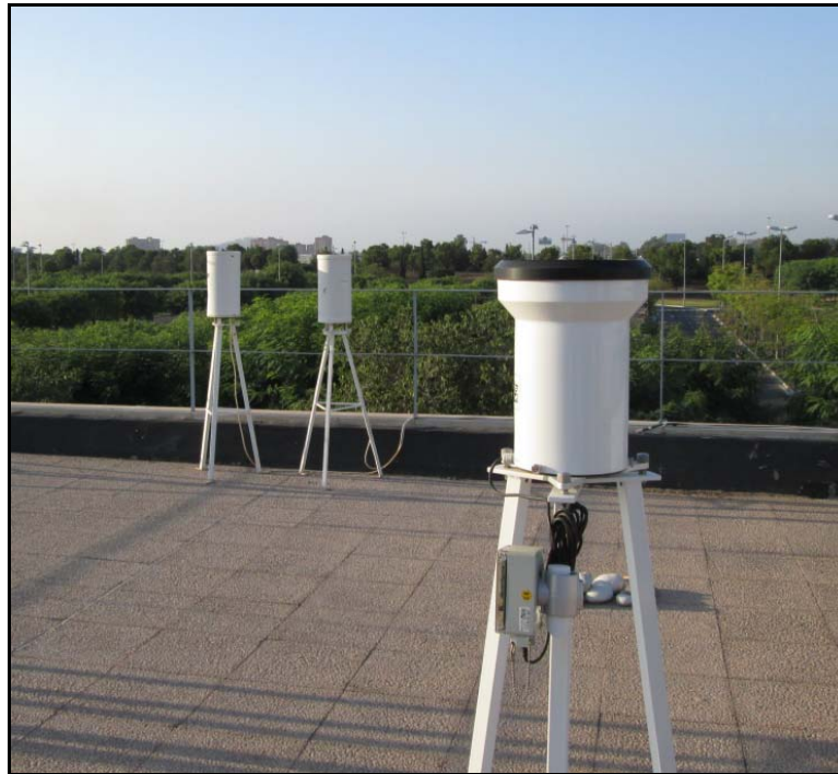
Figura 4. Pluviómetro de última generación (Delta OHM) y Pluviómetros (al fondo de la imagen). Foto del autor.
