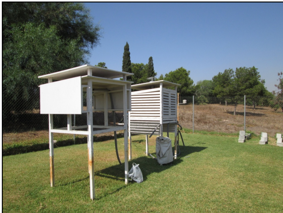
Figura 7. Observatorio Meteorológico donde se disponen de las garitas de tipo “Montsouris”, “Stevenson” y un “Abrigo Multiplato Campbell”. Foto del autor.
