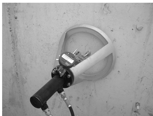
Figura 1: Ensayo de arrancamiento anclaje-soporte.
