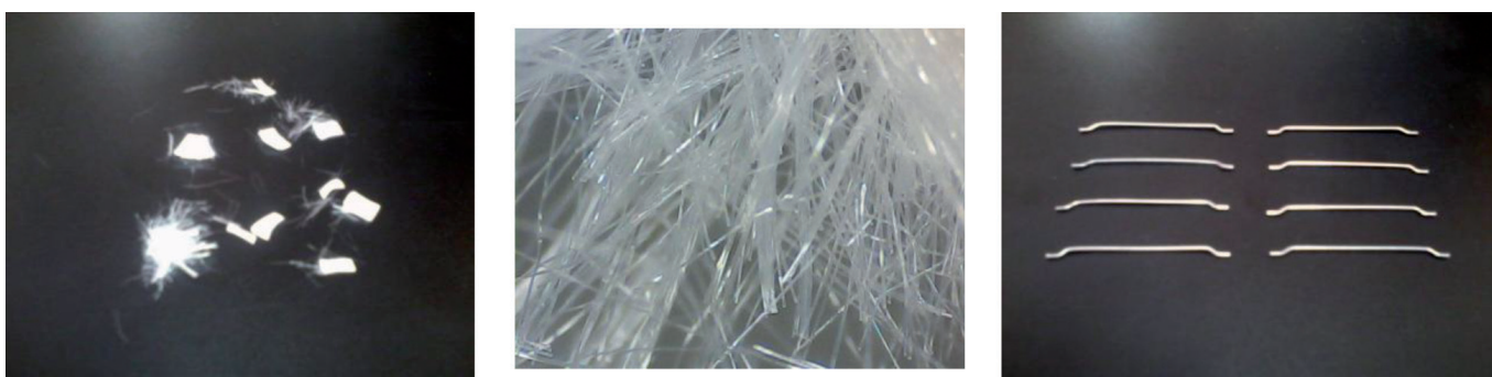
Fig. 2: Fibras de polipropileno (izquierda E 1:1 y centro: E 20:1) y de acero (derecha) empleadas en el estudio experimental
