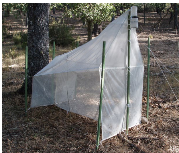
Figura 1. Ejemplo de una trampa Malaise utilizada para la interceptación de insectos al vuelo.
