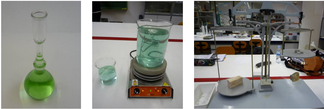
Figura 4.- Material e instrumental necesario para la Práctica 3 . (a) picnómetro lleno del líquido problema. (b) instrumental para la preparación del líquido problema. (c) balanza hidrostática para la determinación de la densidad del sólido problema.
