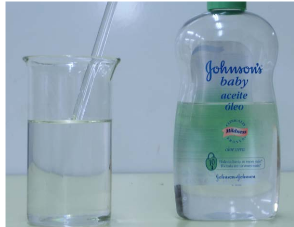
Fig. 2.6.- Invisibilitat òptica aconseguida a la llum natural quan introduïm una vareta de vidre pyrex en oli de bebè.
