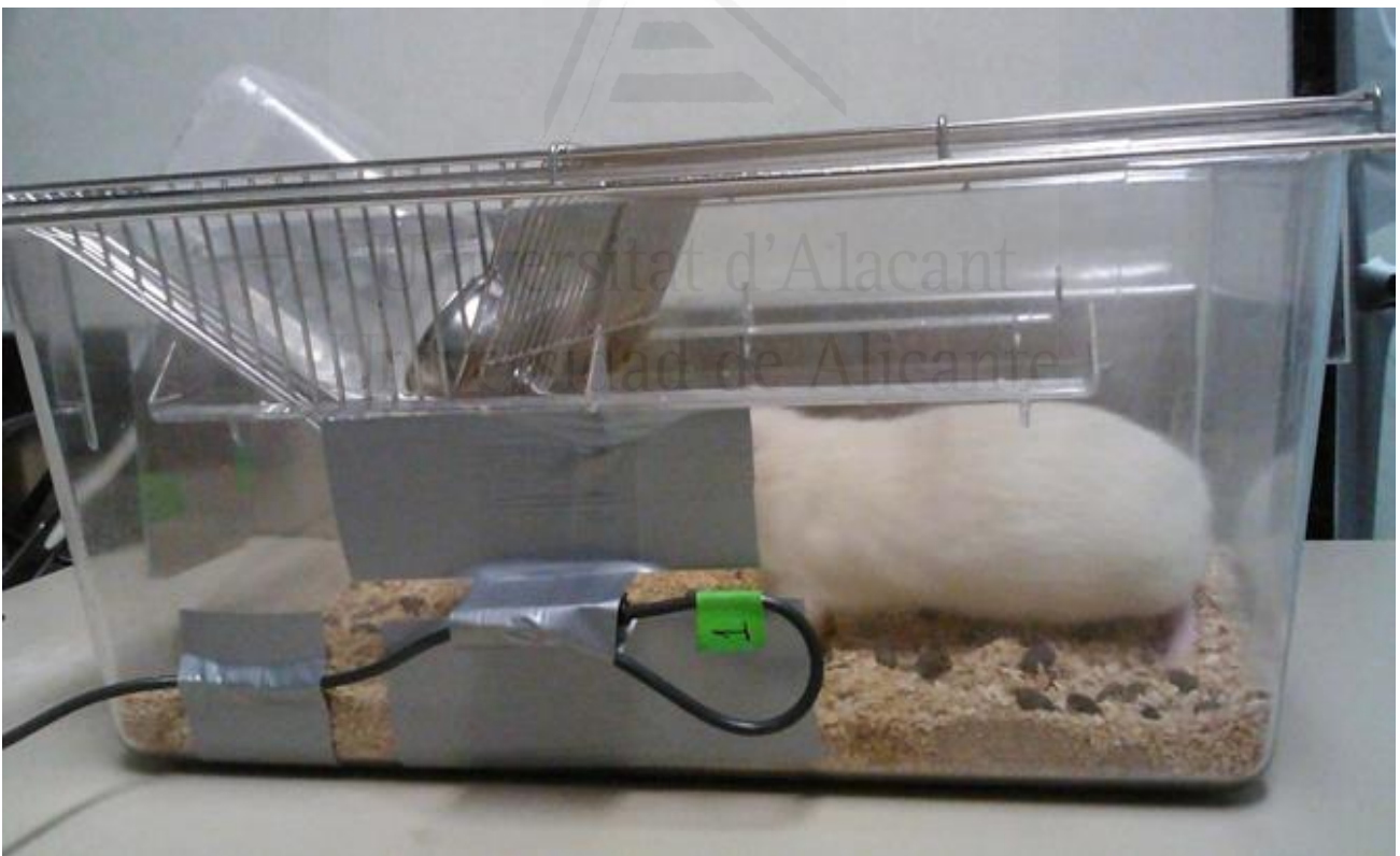
Figura 22. Jaula individual con fotosensor eléctrico (fotocélula) de rayos infrarrojos
