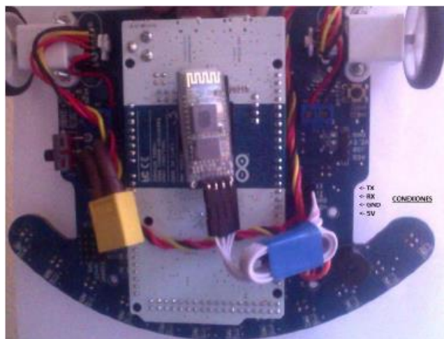
Figura 7. Conexión módulo bluetooth al robot modular.
