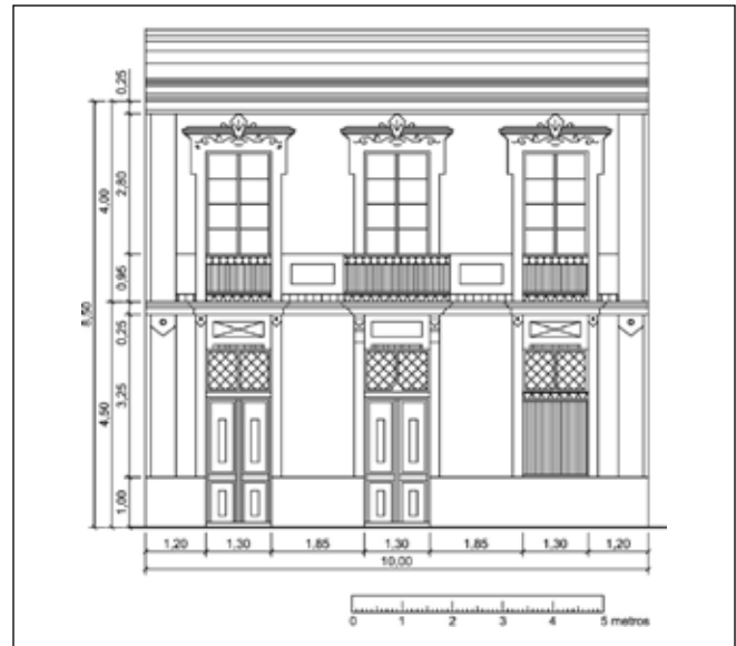
FIGURA 7 | alzado del módulo de fachada de una casa propuesta por Guardiola. Redibujado y acotado. Cotas en metros. Fuente: Raquel Pérez.
