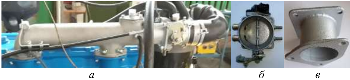
Рис. 7. Основні елементи системи наповнення циліндрів зарядом робочої суміші: а – впускний трубопровід (у зборі), встановлений на Д-240-LPG; б – дросельна заслінка; в – перехідник
