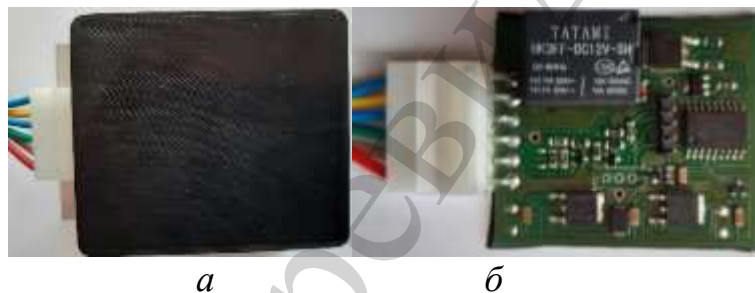
Рис. 5. ЕБУ Avenir Gaz: а – зовнішній вигляд ЕБУ; б – зовнішній вигляд плати ЕБУ Avenir Gaz
