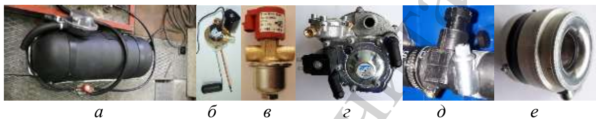
Рис. 4. Основні елементи система живлення газового Д-240-LPG: a – газовий балон для ЗНГ; b – мультиклапан з інтегрованими дистанційно керованим запірним клапаном і датчиком-показником рівня ЗНГ; c – газовий фільтр з дистанційно керованим запірним клапаном; d – двохступінчатий газовий редуктор-випарник із інтегрованим дистанційно керованим запірним клапаном; e – механічний дозатор газу; e – газоповітряний змішувач
