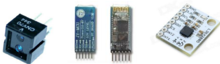
Figura 3. Sensores del robot modular (CNY70, módulo bluetooth, giroscopio)
