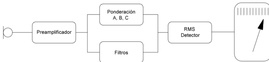
Figura 2. Esquema básico de un medidor de presión sonora
