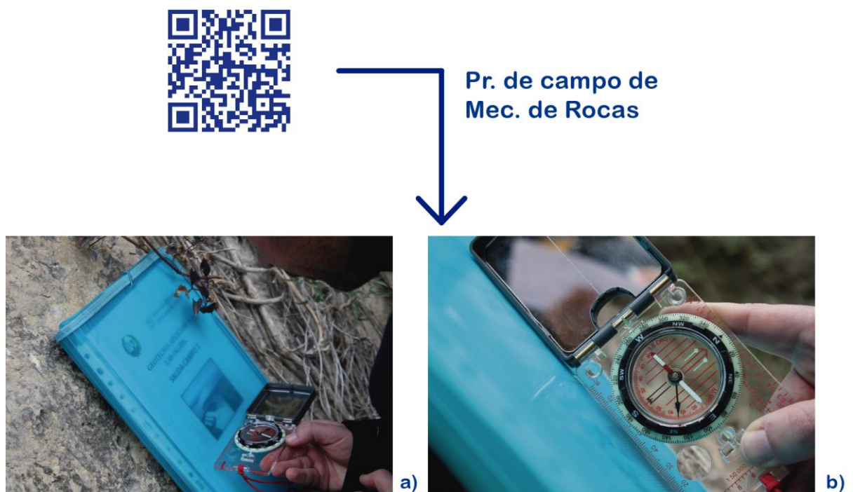
Figura 6. Detalle del enlace a través de la lectura de un código QR llevado al campo con la página web de las prácticas de campo de Mecánica de Rocas y concretamente con el procedimiento de medición de dirección (a) y buzamiento (b) de una superficie rocos con una brújula convencional
