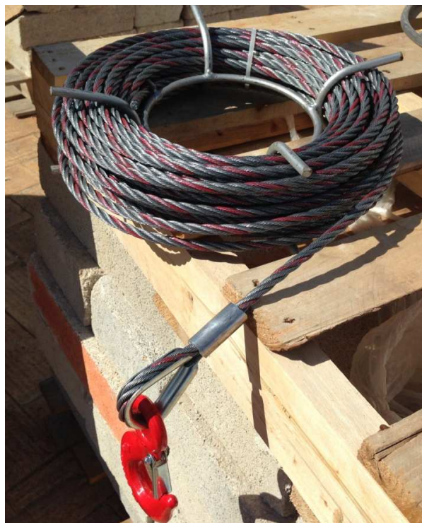
Figura 11. Cable de seguridad. Fuente: Elaboración propia.
