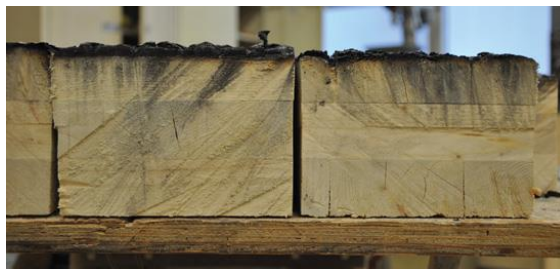
Figura 2.4. Pieza de madera gruesa carbonizada a un ritmo predecible. (Fuente: http://construction.com/CE/CE_images/2013/Oct_reThink-Wood-American-Wood-Council-and-FPIinnovations-9.jpg )
