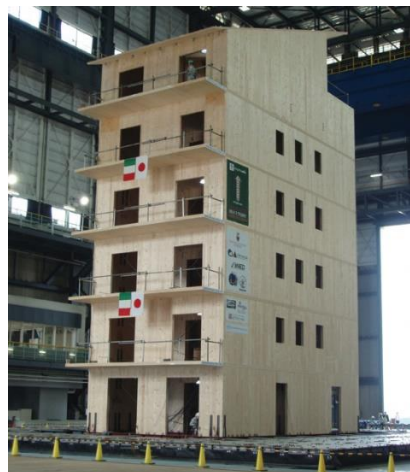
Figura 2.5. Pruebas de estabilidad sísmica de un edificio de paneles de madera contralaminada en la mesa de sacudida más grande del mundo (Japón). (Fuente: http://construction.com/CE/CE_images/2013/Oct_reThink-Wood-American-Wood-Council-and-FPIinnovations-4.jpg )
